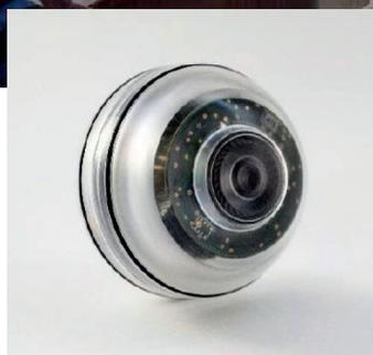
*Détection de fuites par balle traceuse : une expérimentation menée en 2020*
